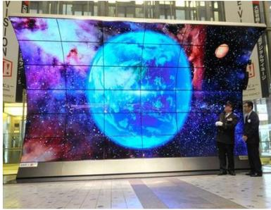
JR博多駅の博多口側コンコースに国内最大級の有機ELディスプレイが登場し、1日から映像を流し始めた。縦約4メートル、横約7メートルの330インチ。4月から電子看板として本格的に移働するが、まずはデモ映像を流す。「博多駅の新しい待ち合わせの目印に」とJR九州グループ。大日本印刷と韓国・LGグループが開発。55インチの画面を36枚つなげ、上部は大きく湾曲している。
