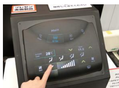
アキレスが開発中の皮革調立体タッチパネル
