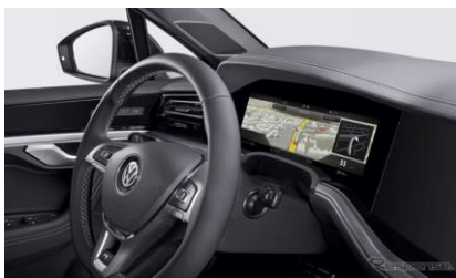
ボッシュの曲面パネルを使用したデジタルメータークラスター
