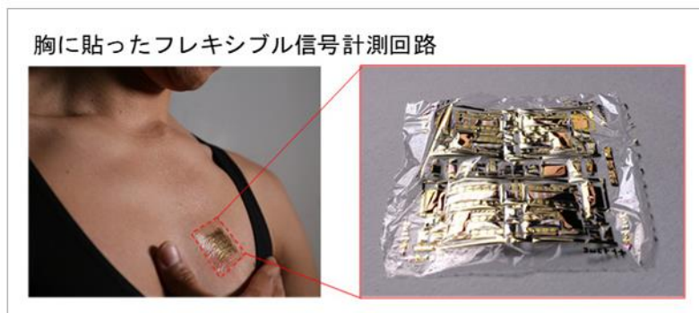
図2 人の胸に貼ったフレキシブル有機差動増幅回路
