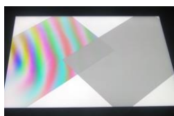
通常ポリエステルフィルム（左）と虹ムラが発生しない超複屈折フィルム
