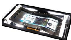
長辺可変曲面の液晶パネル
