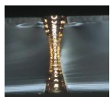
半導体向けガラス基板への穴加工の様子
