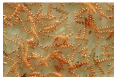
スピルリナ（左）に無電解メッキで金属被膜を形成し、マイクロコイルを得る
