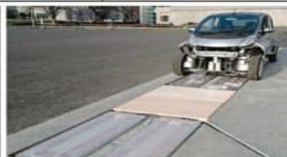
東大は磁界共鳴方式で電気自動車（EV）の走行中給電システムを開発中
