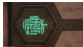
Mojo Lens が搭載する超小型ディスプレイ。
