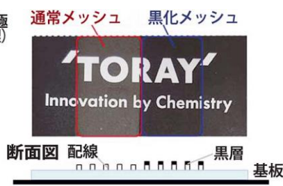
配線黒化技術による反射低減効果
