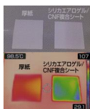
開発した断熱材と紙の断熱性比較。下は100℃に加熱したホットプレート上のサンプルの
