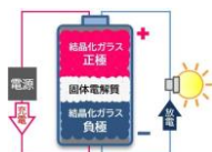
開発した電池の内部のイメージ
