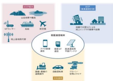
図4 NTNの想定用途 地上の通信網の圏外エリアにおける建物・農機などの遠隔運用、ドローンや空飛ぶクルマ、自動運転車などの通信手段として有望視されている。（出所：日経クロステック）
