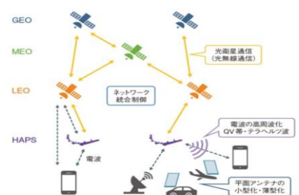
図6 理想のNTN実現のための要案技術 マルチオービット化や地上通信との統合を目指した技術開発における重要ポイントを示した。（出所：日経クロステック）
