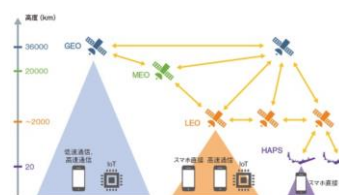
図2 NTNを提供する衛星などの軌道とサービスの種類 衛星の高度によって、提供するサービスの特性が変わってくる。（出所：日経クロステック）
