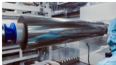
「ロール・ツー・ロール」方式により安定的な量産体制を実現する
