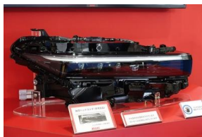
意匠性に配慮した小糸製作所の「融雪ヘッドランプ」
